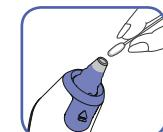
Stergeți atent suprafața cu un tampon de bumbac sau o cârpă moale, umezite cu alcool. După uscarea completă, puteți monta un capac igienic și puteți realiza măsurarea temperaturii. Dacă vârful sondei este deteriorat, contactați Serviciul Relații Clienti.
